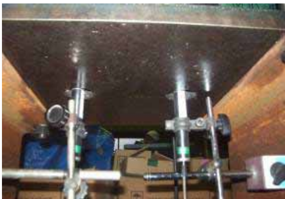
写真 3-11 変位計設置状況（試験装置下面）
