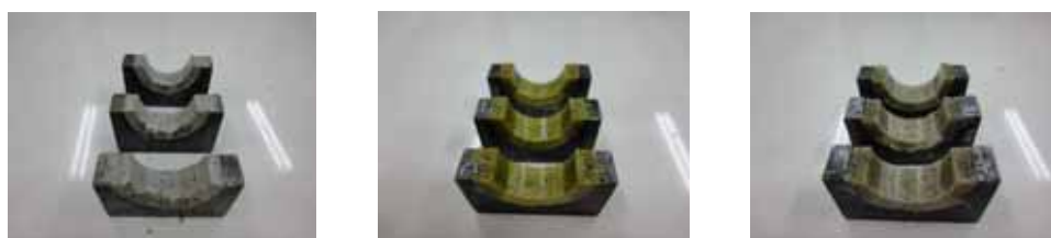
写真 4-8c 肉厚 5.0 mm の試験後の状態
