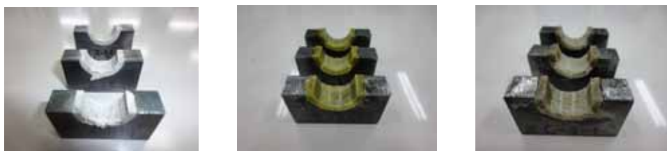
写真 4-8b 肉厚 3.0 mm の試験後の状態
