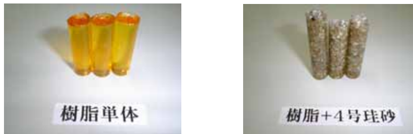
写真 4-1 切断前の試験体 ( \phi 10.5\text{ mm} \times L40\text{ mm} )
