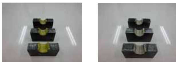
写真 4-8a 肉厚 1.5 mm の試験後の状態
