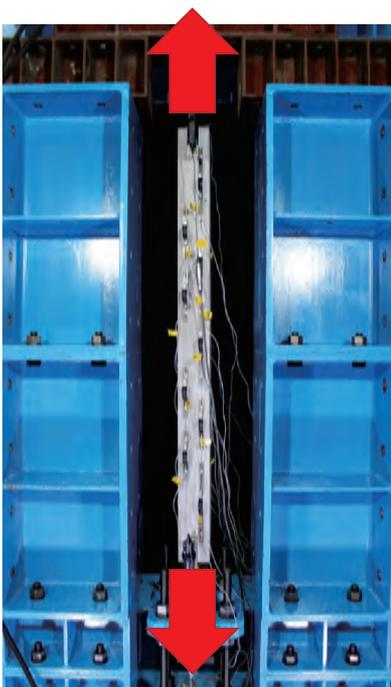
ひび割れ間隔・幅確認実験
