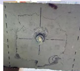
割裂破壊の例(引張側中央No.10)
