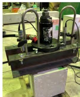
境界条件: 型鋼+鋼板を用いて、二辺を支持反力として引張力を作用
