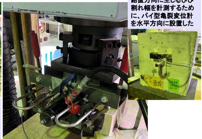
鉛直方向に生じるひび割れ幅を計測するために、パイ型亀裂変位計を水平方向に設置した
