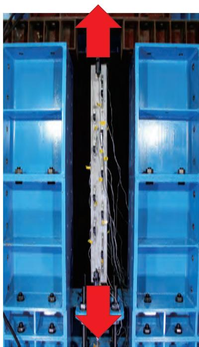
ひび割れ間隔・幅確認実験
