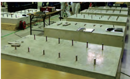
施工不良を模擬した試験体(JCAA技術センター)
